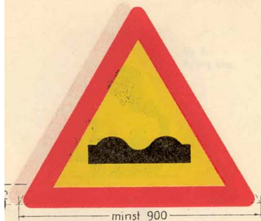
fig. 1. Gupp eller ojämn väg.
